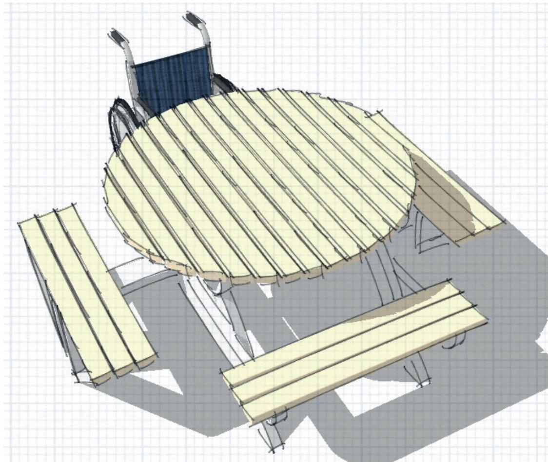
Ce projet est réalisé en bois de récupération, il tient compte de la proximité du quartier générateur d'emploi pour une entreprise de travail adaptée ; **La Ferme Nos Pilifs**. Il est démontable pour faciliter le déplacement lors de différents événements intérieurs/extérieurs.
